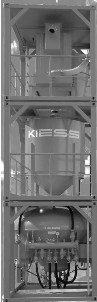
Strahlmittelaufbereitungsturm mit Sauganlage für den mobilen Einsatz
